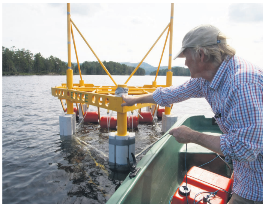
LETET ETTER VIND: For fem år siden begynte Gunnar Ettestøl på jobben med å lage en rigg som kunne brukes til vannrensing til havs. Nå er den kombinerte bølge- og vindkrafttrigg ferdig. Her drar han med seg riggen ut over innlandsvannet Vegår på jakt etter rette vindforhold. FOTO: KJETIL REITE
